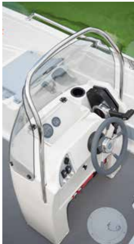
Funktional gestalteter Steuerstand mit Acrylglas-Windschutzscheibe, mechanischer Lenkung, griffgünstig positionierter Schaltung und in einem Fach montierten Motorinstrumenten. Der Batterieschalter und ein Feuerlöcher befinden sich im Fußraum
